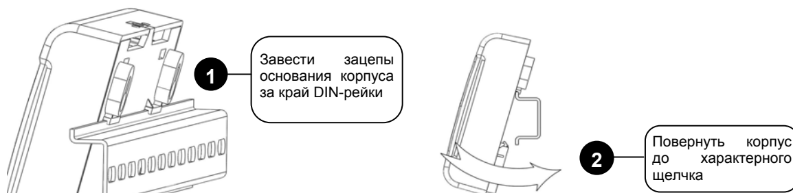
Рисунок 4. Монтаж прибора на DIN-рейку
