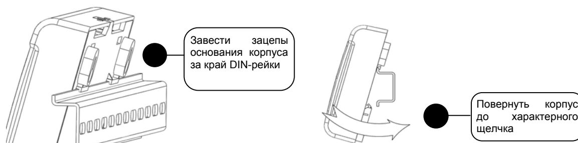
Рисунок 4. Монтаж контроллера на DIN-рейку
