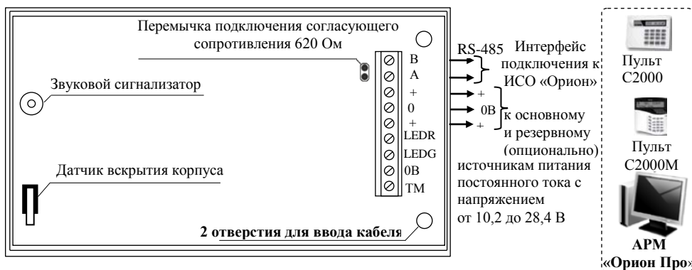
Рисунок 3. Схема внешних соединений блока
