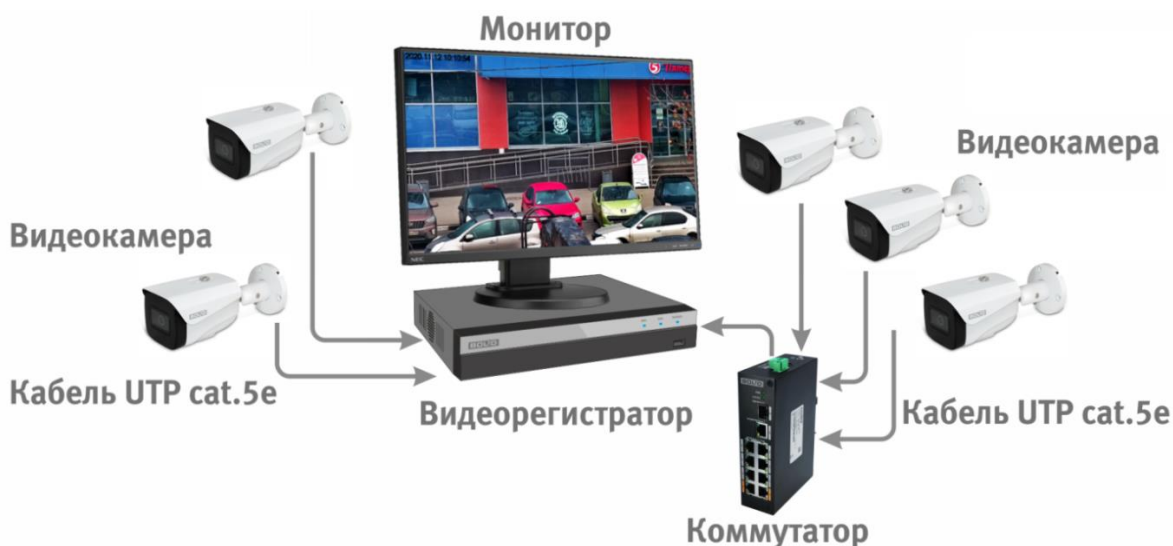
Рисунок 6.4 – Схема подключения видеокамеры к видеорегистратору
