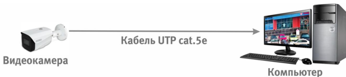
Рисунок 6.2 – Схема подключения видеокамеры к компьютеру
