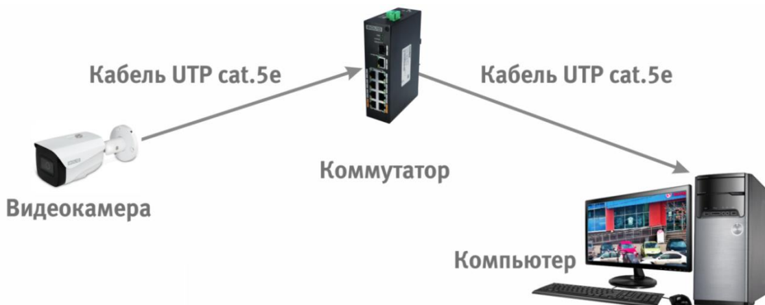
Рисунок 6.3 – Схема подключения видеокамеры к компьютеру через коммутатор
