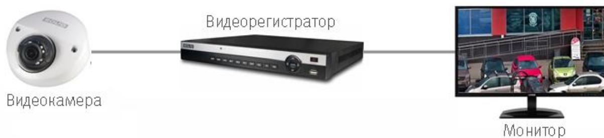
Рисунок 6.2 – Схема подключения видеокамеры
