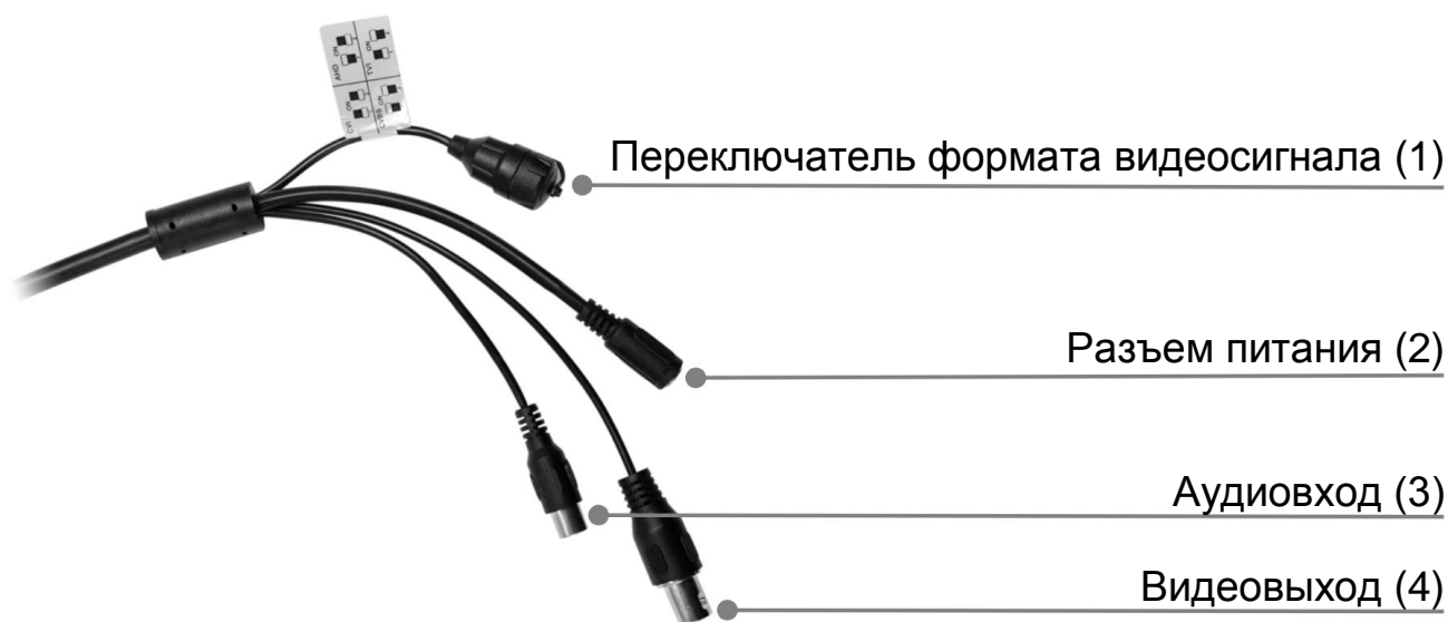
Рисунок 6.1 – Концевая раскладка кабеля видеокамеры
