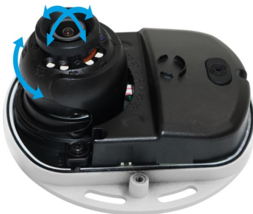
Рисунок 6.5 – Настройка направления объектива
