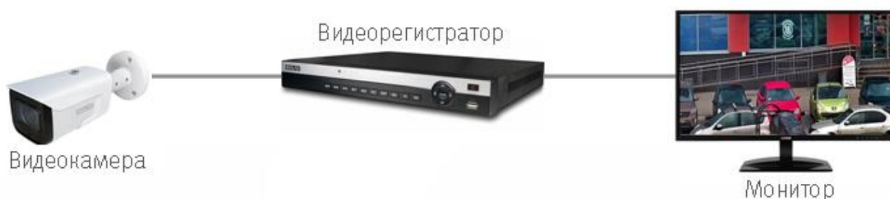
Рисунок 6.2 – Схема подключения видеокamеры
