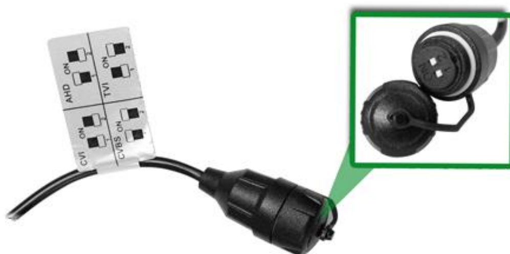
Рисунок 6.3 – Переключатель формата видеосигнала
